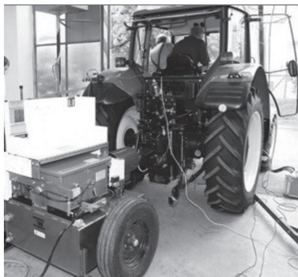
Fig. 2. AW NEB 400 dynamometer.
