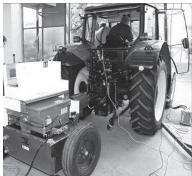
Fig. 2. AW NEB 400 dynamometer.
