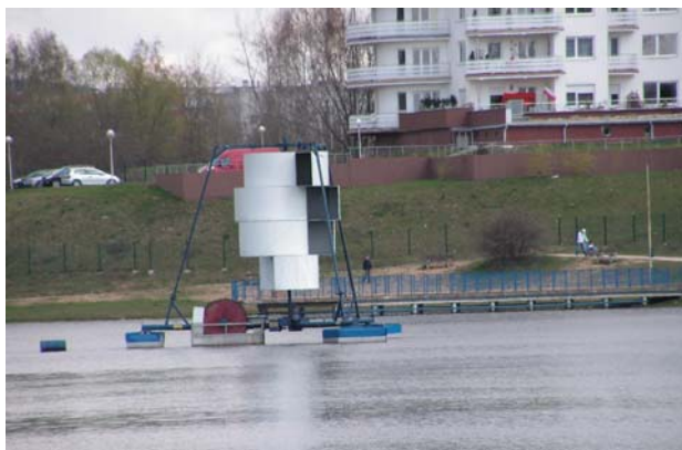
Fig. 1. Aerator in Kielce Lake (fot. A. Rabajczyk, 2008).
